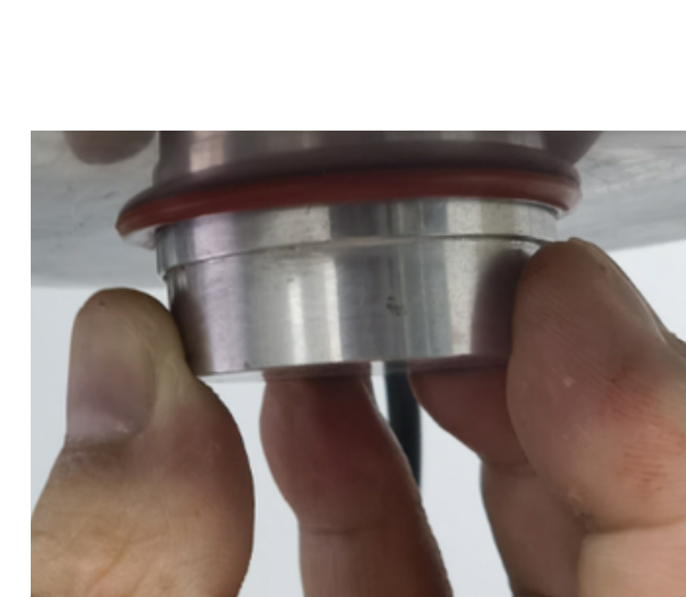
塑料油箱不要使用AB胶 用红色卡夫特硅红胶代替
